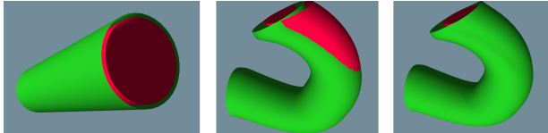
Figure 7: A gauche, deux cylindres jouent le rôle de deux couches de vêtements. La couche rouge est censé être sous la verte. Au milieu, après le skinning, les vêtements sont en intersection. A droite, les intersections sont corrigées.
