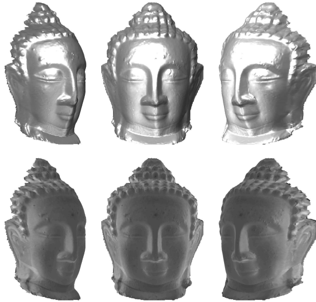
Figure 17. Reconstruction 3D du buste de Buddha, sous différents angles. Première ligne : relief rééclairé. Deuxième ligne : modèle 3D (avec plaquage de l'albedo).
