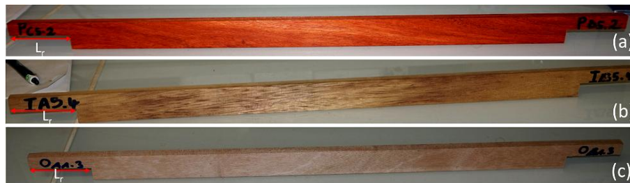
Figure 3. Configuration des éprouvettes à charger à l=38,3 mm avec Lr=63,3 mm (a) ; Padouk (b) Iroko (c) ; Okoumé
