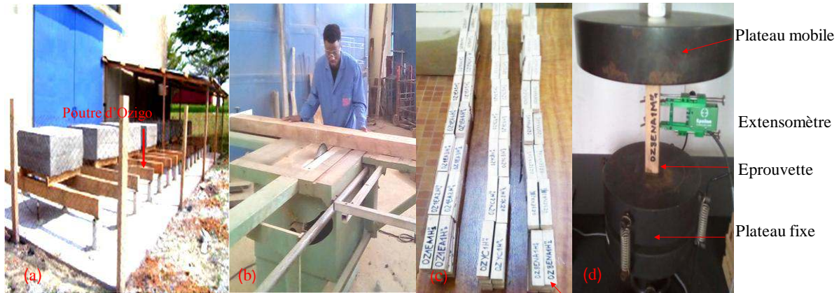
Fig. 1 : (a) Ambiance extérieure non abrité. (b) Sciage de la poutre. (c) Eprouvettes de compression du milieu extérieur non abrité (haute, médiane et basse). (d) Dispositif expérimental d'essai de compression
