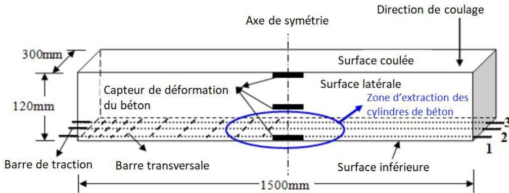
Figure 1 – Dimensions de la poutre en béton armé
