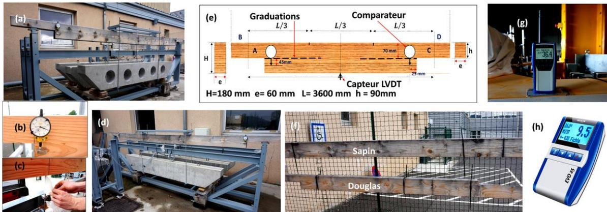
**Figure 1** : dispositif expérimental (a) ; chargement poutre sapin blanc (b) ; comparateur (c) ; capteur LVDT (d) ; chargement poutre sapin blanc et Douglas (e) ; configuration des poutres testées (f) ; poutre témoins pour le suivi de (HI) (g) ; thermo hygromètre (e) ; humidimètre (h)
