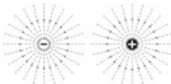
Figure 1 : Dans le cas de monopôles, les lignes de champ électrique sont radiales. Elles sont divergentes pour une charge positive et convergentes pour une charge négative.
