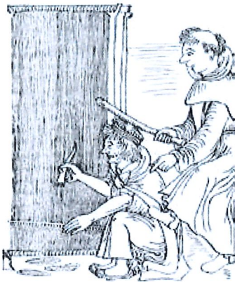
36. Métier à tisser andin à tension variable contrôlée par une ceinture (d'après Guaman Poma de Ayala, 1615).
