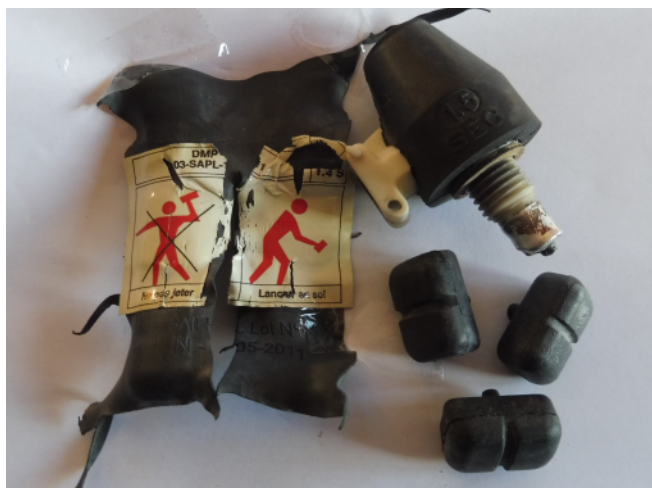
Restes d'une grenade de désencerclement ramassés dans une rue de Toulouse. On voit l'enveloppe qui indique que cette grenade doit être roulée au sol et non lancée, la tête de la grenade et trois des plots sur les dix-huit qu'elle projette.
