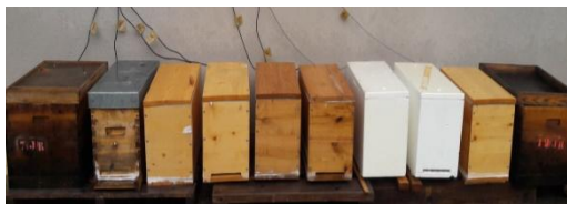
Fig. 2 : Ruches instrumentées constituées de différents matériaux
