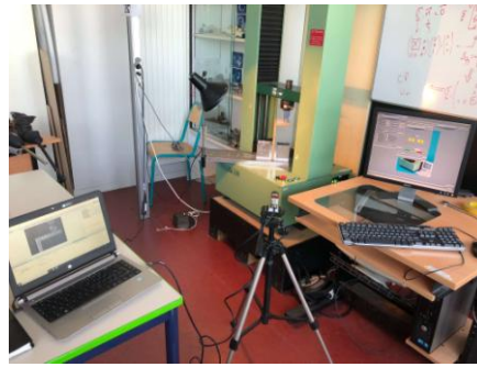
Fig. 2 : Dispositif d'essai expérimental pour l'identification des rigidités des jonctions
