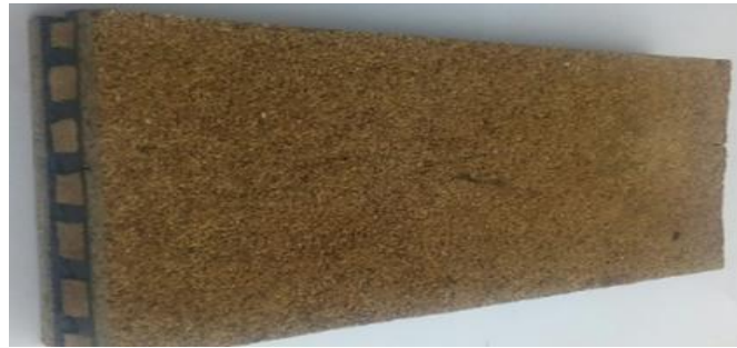
Fig. 5 : Prototype de sandwich réalisé
