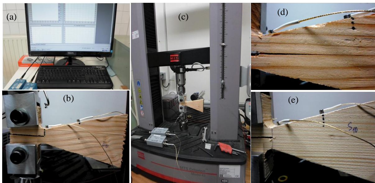
Fig. 1: Matériaux, éprouvette DCB, configuration expérimentale : (a) Équipement acoustique – (b) Éprouvette DCB (Douglas) instrumentée – (c) machine d'essai – (d) propagation de fissure pendant l'essai – (e) Éprouvette DCB (Sapin blanc) instrumentée
