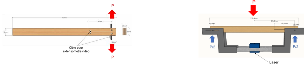
Fig. 1 : Schémas de l'essai de mode I (spécimen DCB) à gauche et de l'essai de mode II (spécimen ENF) à droite avec leur système de mesure et de pilotage.
