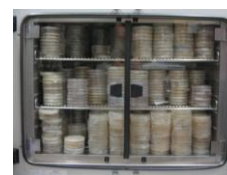
Fig. 6 : Incubation à 22°C et 75% d'humidité relative
