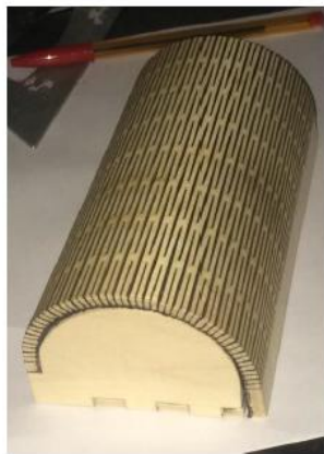
Fig. 7 : Prototype de boîte à lunettes en treillis charnière contreplaqué
