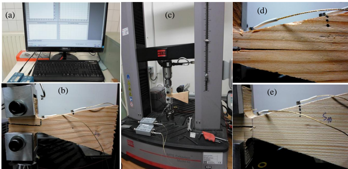
Fig. 1: Matériaux, éprouvette DCB, configuration expérimentale : (a) Equipement acoustique – (b) Eprouvette DCB (Douglas) instrumentée – (c) machine d’essai – (d) propagation de fissure pendant l’essai – (e) Eprouvette DCB (Sapin blanc) instrumentée
