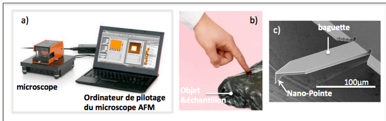
Figure 5: (a) microscope à force atomique piloté par ordinateur via un logiciel dédié ; (b) un doigt pour palper les contours d'une pierre ; (c) Image d'une sonde AFM constituée d'une micro-baguette souple au bout de laquelle est fixée une nano-pointe qui agit comme un nano-doigt.
