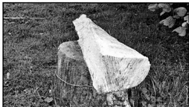
Fig. 7. Ce morceau d'ébène a un fil tors qui s'est révélé lorsqu'il a été fendu. Il est inutilisable pour la fabrication d'un arc
