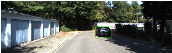
FIGURE 6 – Détection 2D sur une image de KITTI avec YOLO9000 pré-entraîné sur la base [9]. On voit que la détection (rouge) est très proche de la vérité terrain (vert).
