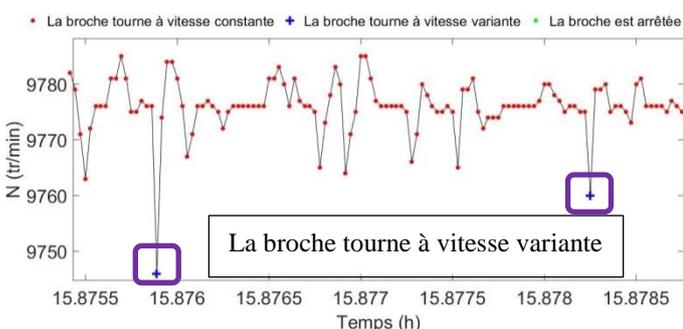
Fig. 11 Classification de N en 3 clusters selon  $T_{\Delta N}=2,2 \text{ tr/s}^2$  en zoom la zone 1
