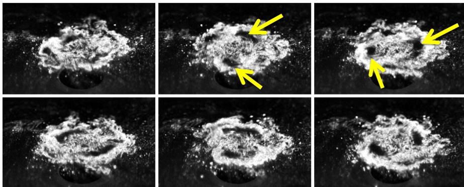
Figure 5: Vues tomographiques horizontales successives, à  $z = 5$  mm de la sortie de l'injecteur. Photos prises en plongée. La séquence se lit de gauche à droite, puis de haut en bas. Par rapport à l'enregistrement réel, il n'est présenté qu'une image sur 5, ce qui correspond à une cadence de 20 000 im/s. Les flèches jaunes indiquent les zones dépressionnaires correspondant aux bras des PVC.
