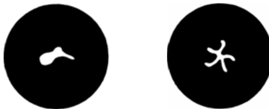
Figure 3: Schémas des buses en forme d'oiseau (gauche) et d'étoile (droite).
