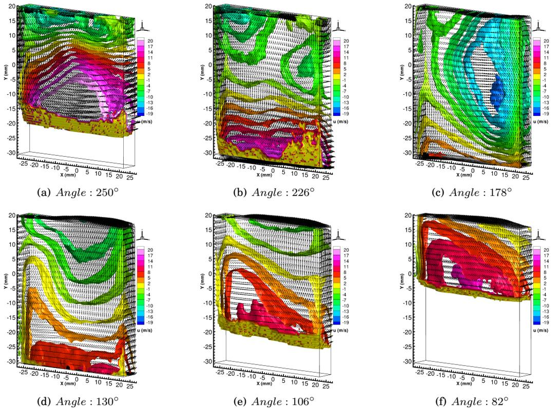
Figure 8: Vitesses moyennes et iso-surfaces de  $u$  (cas  $L8$ ,  $2000\text{ tr/min}$ ,  $P_{ad} = 1\text{ bar}$ ) pendant la phase d'admission ( $250^\circ$ ,  $226^\circ$  et  $178^\circ$ ) et le début de la compression ( $130^\circ$ ,  $106^\circ$  et  $82^\circ$ ).
