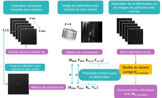
Figure 2: Procédure de calibration *ex-situ*
