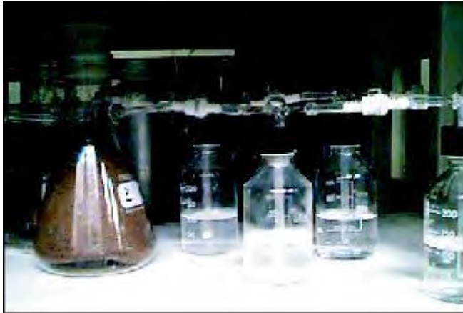
Photo 2. Nouveau test de laboratoire d'évaluation de la biodégradabilité ultime en milieu sol.
