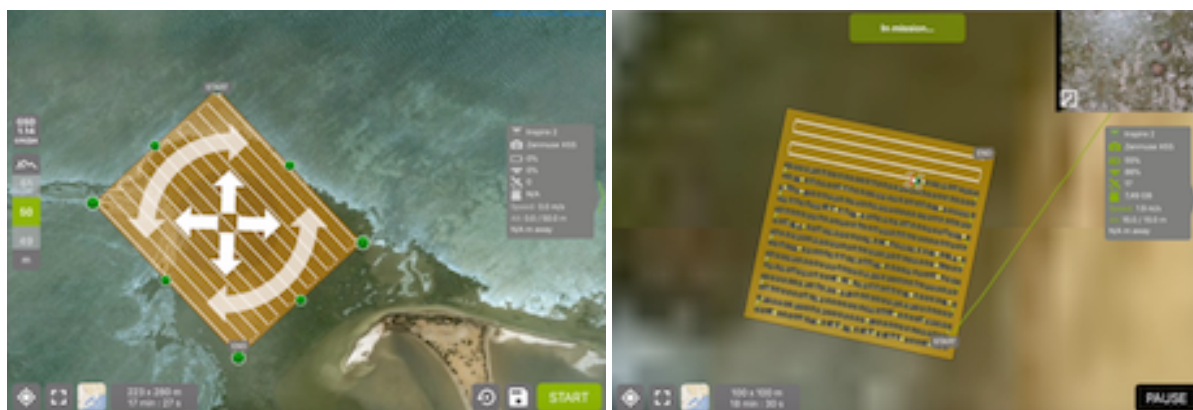
Figure 21 : Définition de la zone d'échantillonnage et plan de vol du drone.
