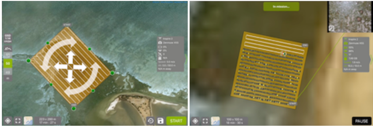
Figure 21 : Définition de la zone d'échantillonnage et plan de vol du drone.
