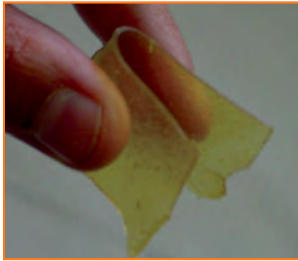
Figure 10 - Matériau à base d'huile de lin standolisée à 30 % et modifiée à 10% après photopolymérisation [10].
