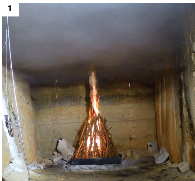
Fig. 10 - Expérimentations du programme CarMoThaP. 1 : Allumage du foyer avec 4 fagots disposés en tipi. 2 : Etat du feu après 50 mn de combustion. Les flammes atteignent le plafond. La partie claire correspond à la coloration grise acquise par la surface du calcaire (extraits d'une vidéo, LCPP).
