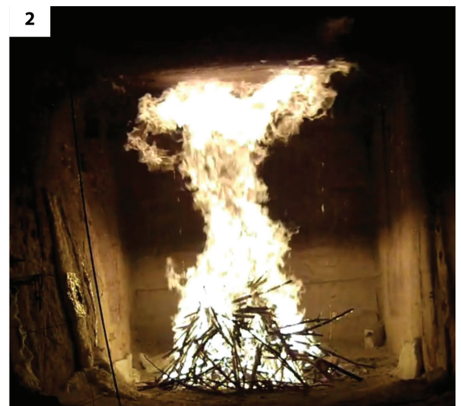
Fig. 10 - Expérimentations du programme CarMoThaP. 1 : Allumage du foyer avec 4 fagots disposés en tipi. 2 : Etat du feu après 50 mn de combustion. Les flammes atteignent le plafond. La partie claire correspond à la coloration grise acquise par la surface du calcaire (extraits d'une vidéo, LCPP).
