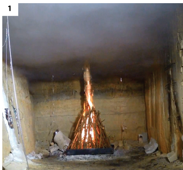
Fig. 10 - Expérimentations du programme CarMoThaP. 1 : Allumage du foyer avec 4 fagots disposés en tipi. 2 : Etat du feu après 50 mn de combustion. Les flammes atteignent le plafond. La partie claire correspond à la coloration grise acquise par la surface du calcaire (extraits d'une vidéo, LCPP).
