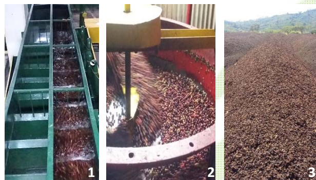
Production du café vert par voie humide : (1) entraînement à l'eau des cerises de café ; (2) callibrage avant dépulpage/démucilage des grains ; (3) stockage à l'air des coproduits (pulpe, peau, mucilage).
