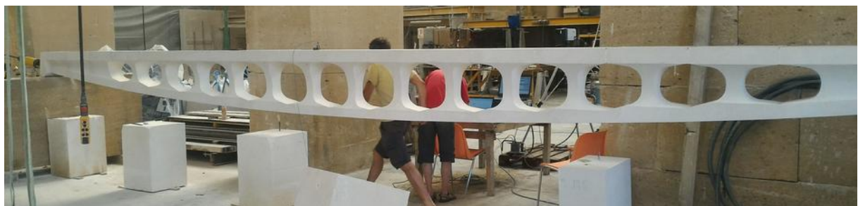
Figure 1 : Poutre en pierre massive précontrainte – 10m de portée.
