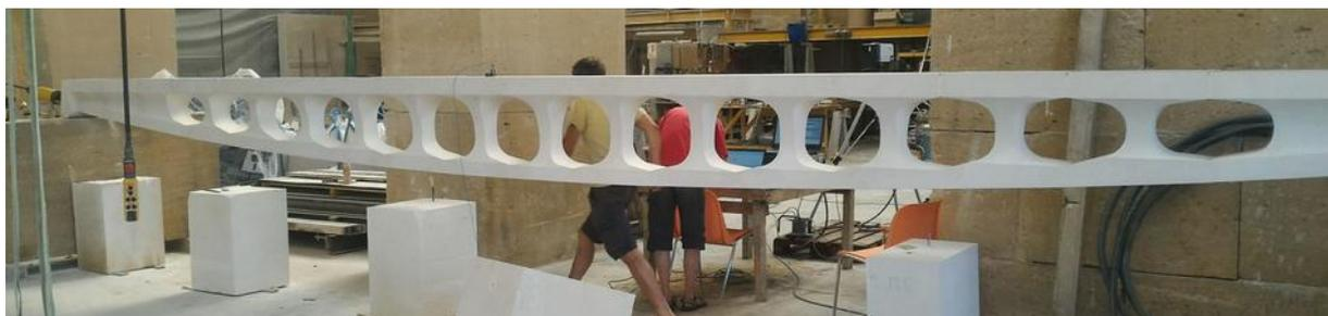
Figure 1 : Poutre en pierre massive précontrainte – 10m de portée.
