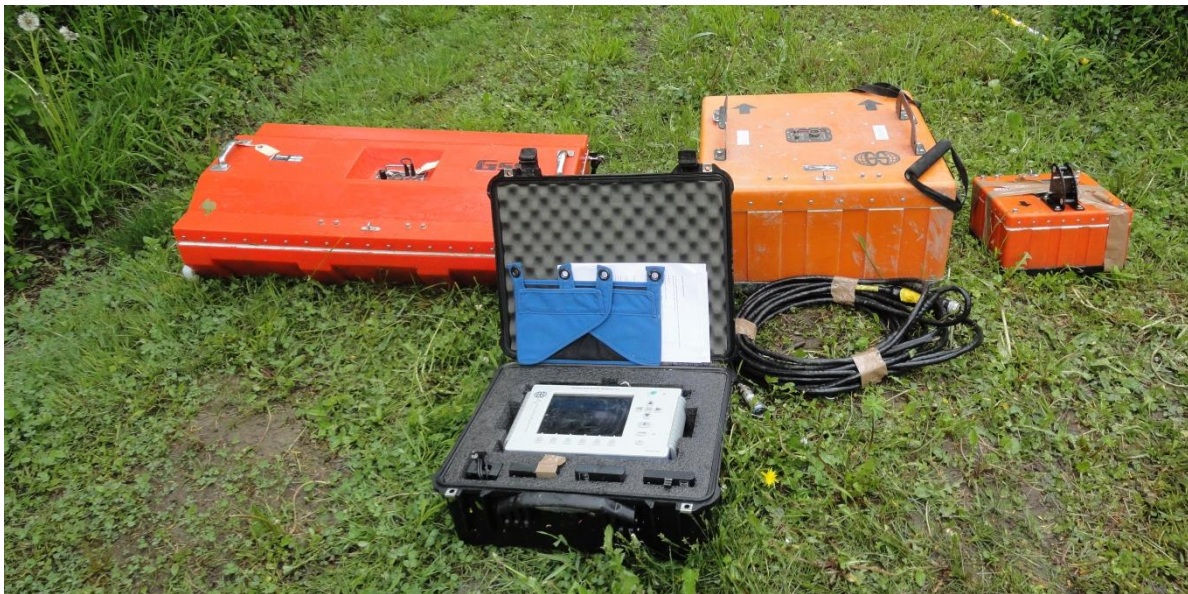
Figure 3 : le SIR-3000 au premier plan, et de gauche à droite les antennes de 100, 200 et 400 Mhz
