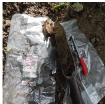
Figure 10. Echantillon prélevé à la tarière pédologique
