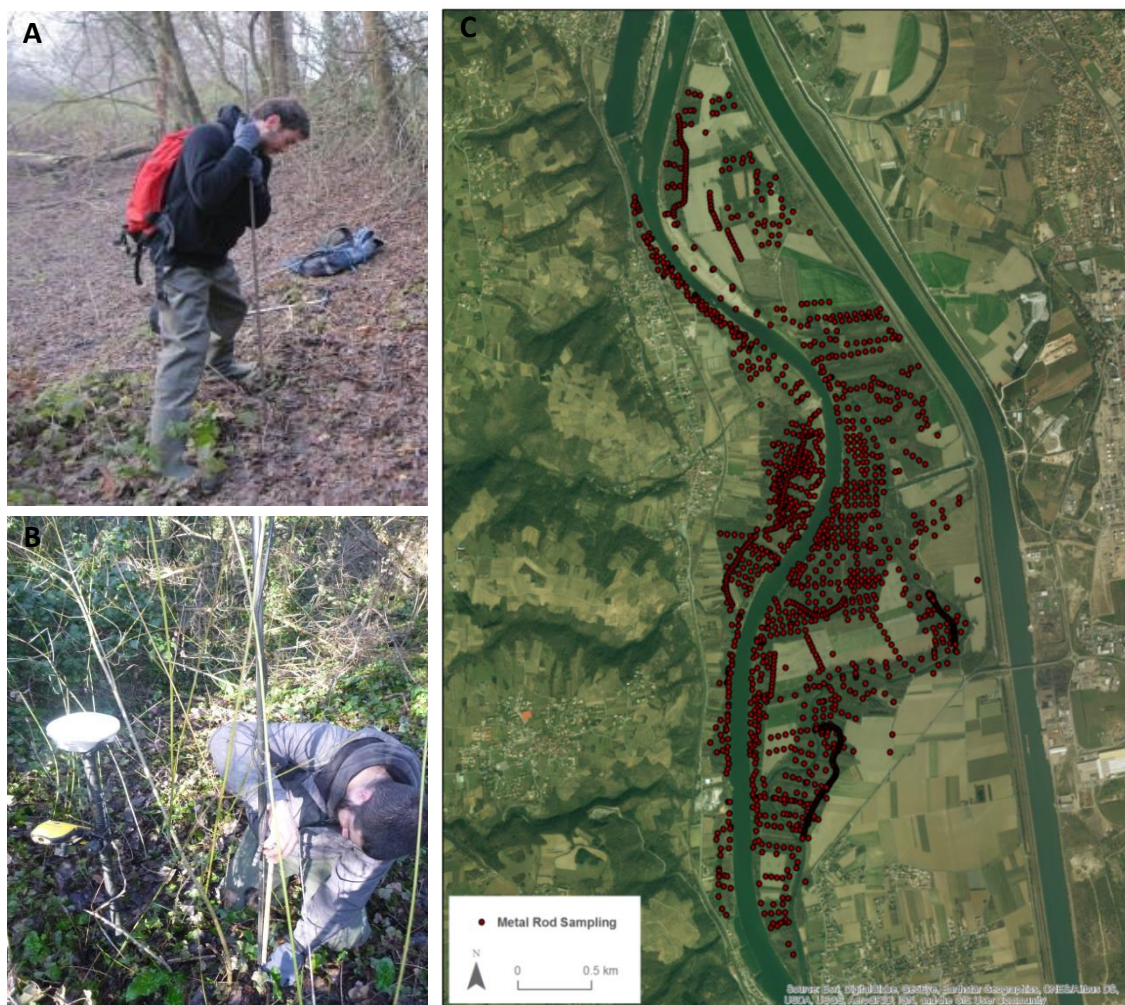
Figure 4. A. Sondage à la perche. B) Géolocalisation et mesure de l'épaisseur de sédiment au niveau d'un point d'observation. C) Localisation des sondages à la perche sur le site de Péage-de-Roussillon.
