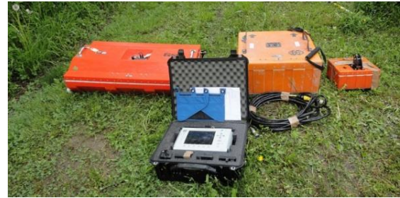
Figure 5. Le SIR-3000 au premier plan, et de gauche à droite les antennes de 100, 200 et 400 MHz.
