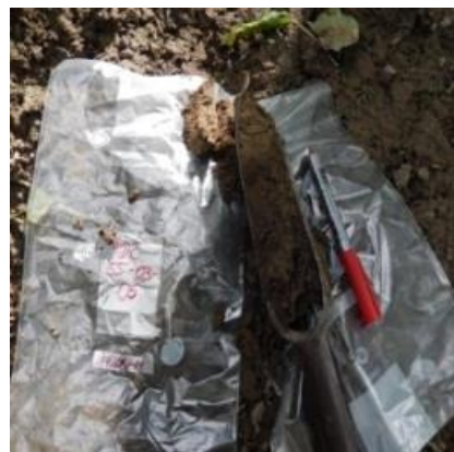
Figure 10. Echantillon prélevé à la tarière pédologique
