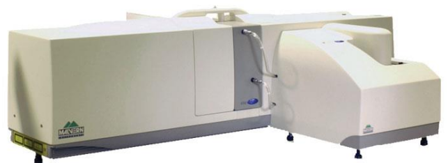
Figure 8. Granulomètre laser Malvern Mastersizer 2000
