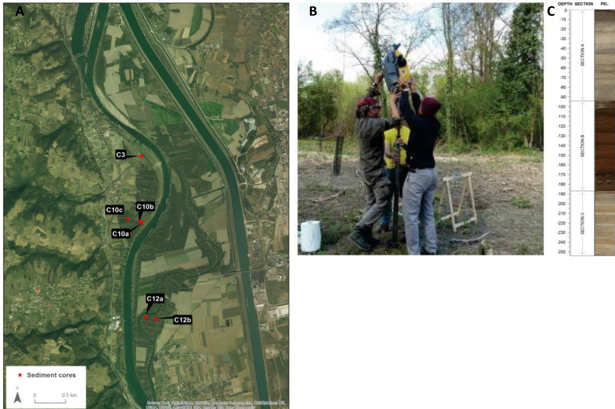
Figure 7. A) Localisation des carottes. B) Mise en place du carottier motorisé à percussion Cobra TT. C) Exemple d'une carotte
