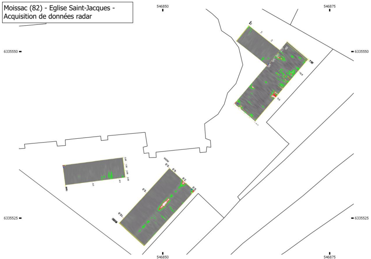
Figure 8 : Géoréférencement des cartes de profondeur (~1m)
