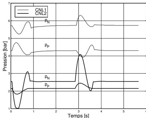
Figure 5: Comparaison des pressions dans les chambres.
