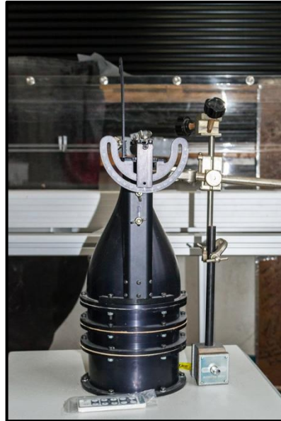
Figure 5. Calibrateur de la vitesse de l'air
