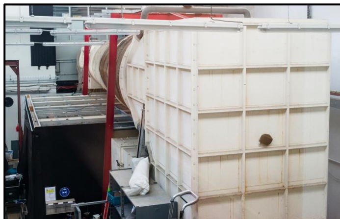
Figure 1. La soufflerie à bas niveau de turbulence
