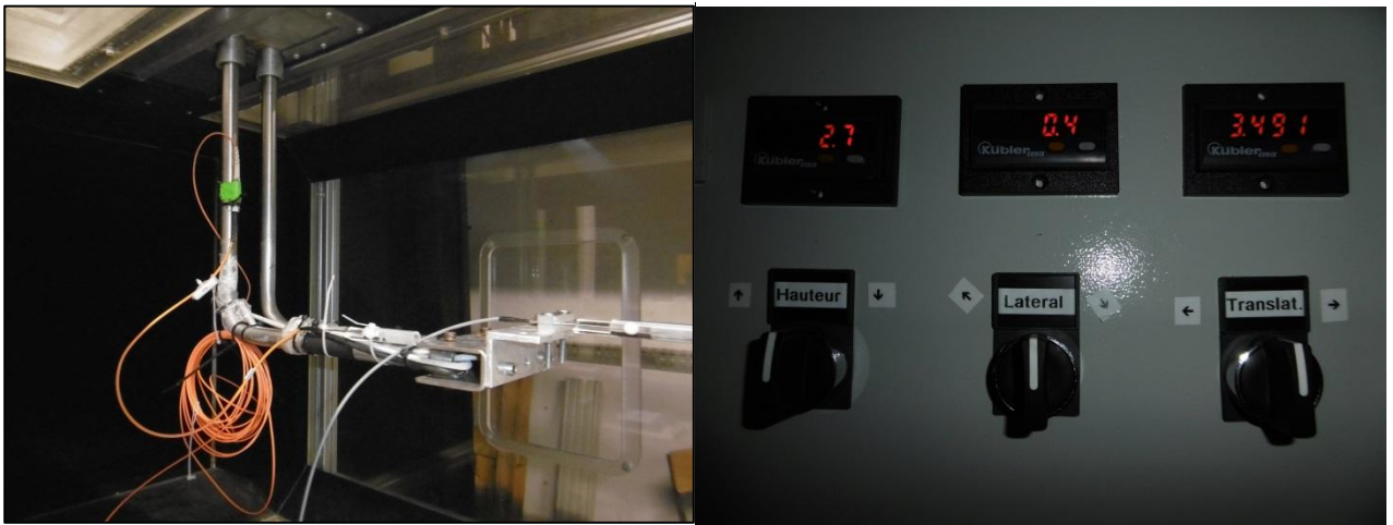
Figure 6. Le système 3D de déplacement des sondes
