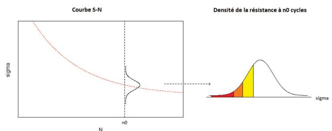
Figure 3 : Courbe S-N et résistance à  $n_0$  cycles
