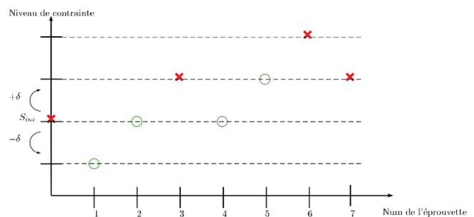
Figure 2 : Procédure Staircase
