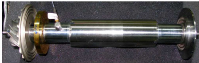
Rotor (frette métallique Inconel – 1100 MPa)
