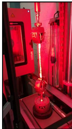
Figure 5 : Dispositif d'essais de fatigue en traction sur fils. Les mesures des déformations sont réalisées par un extensomètre sans contact
