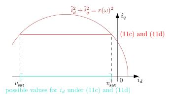
Fig. 3. Voltage limits (11c) in  $(i_d, i_q)$ -plan
