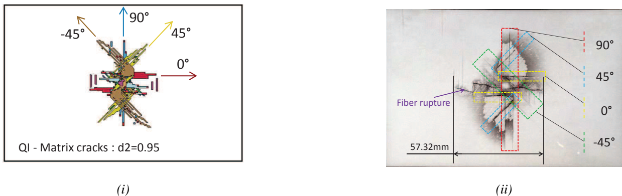
Fig. 12. Comparaison des fissures matricielles entre num. et exp. [Non vieilli T20^{\circ}\text{C} ] 20J (i) num. (ii) exp.
