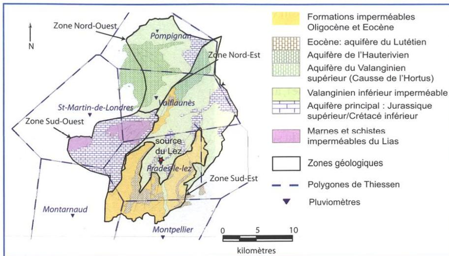
Figure 2: Bassin hydrogéologique de la source du Lez [Kong-A-Siou, 2011] : zones géologiques, pluviomètres et polygones de Thiessen. *The hydrogeological catchment of Lez spring: Geological zonation, rain gauges and Thiessen polygons.*
