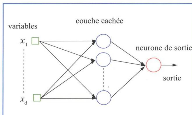
Figure 3 : Réseau Perceptron Multicouche, les ronds représentent les neurones, les carrés correspondent aux variables, les flèches correspondent aux paramètres. *Multilayer Perceptron network. Rings correspond to neurons, squares correspond to variables and arrows correspond to parameters.*
