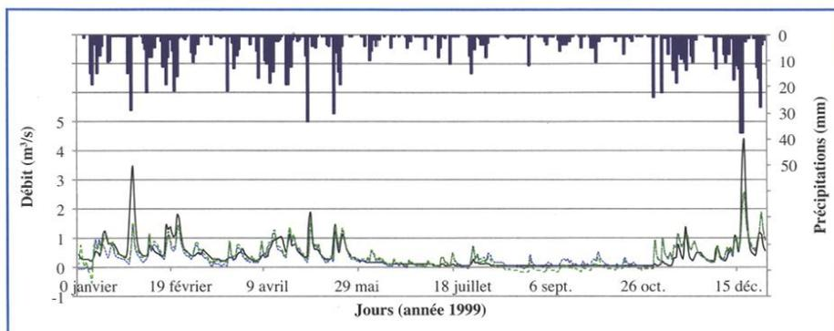
Figure 14: Estimation de débit réalisée par un filtre linéaire. En noir la sortie mesurée, en vert la sortie du modèle linéaire, en bleu la sortie du modèle neuronal. *Estimated discharge by linear filtering. In black, the measured discharge, green the linear filter, blue the output of the neural model.*
