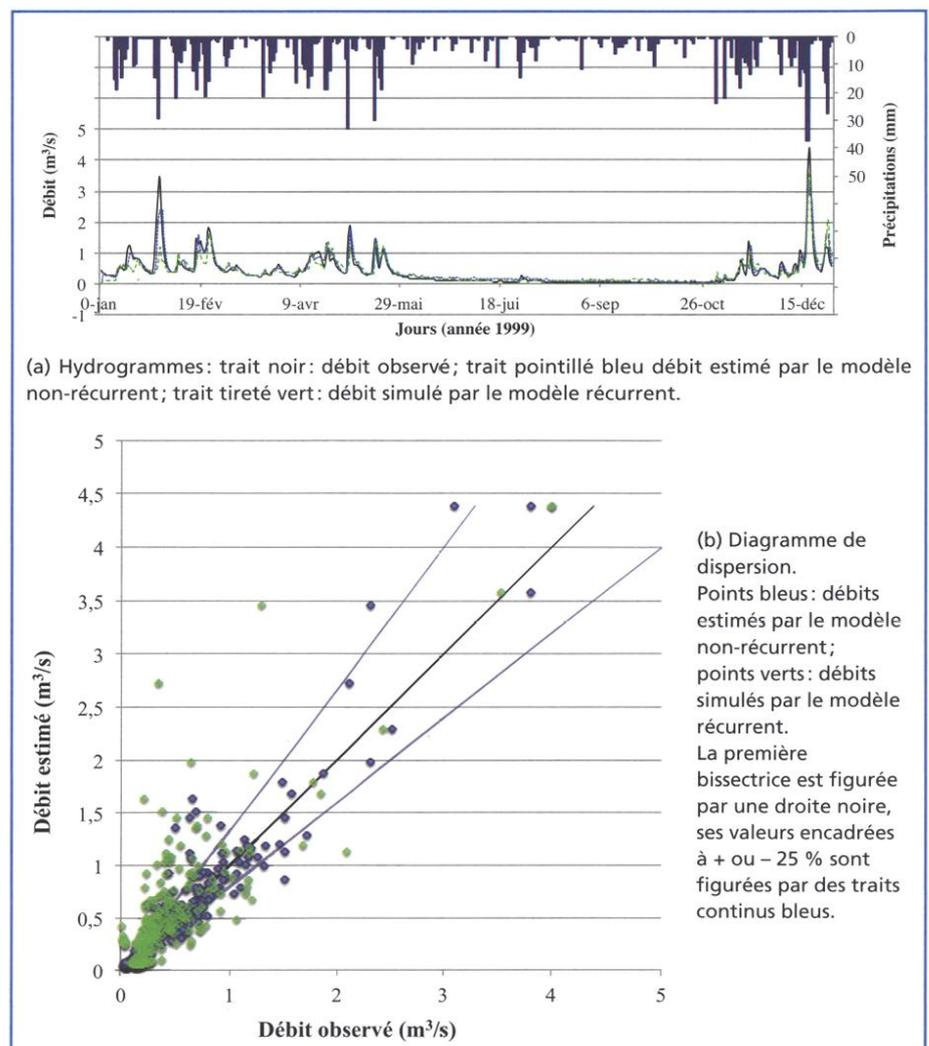
Figure 12 : Simulation du débit du Baget par réseaux de neurones : comparaison des simulations issues du modèle récurrent et du modèle non-récurrent. *Discharge simulation of Baget with neural networks: comparison of simulations with recurrent and non-recurrent model.*
