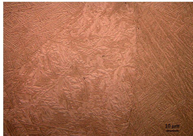
Fig. 3. Zone recristallisée dans un échantillon comprimé de \bar{\varepsilon} = 0,5 , T = 900\text{ °C} , \dot{\varepsilon} = 10^{-1}\text{ s}^{-1} .
