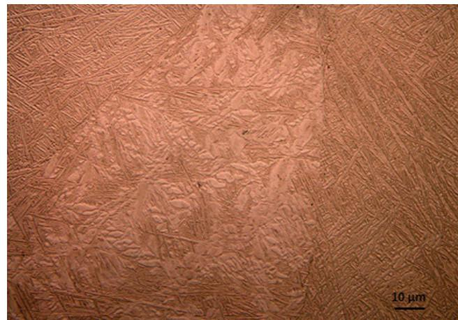
**Fig. 3.** Zone recristallisée dans un échantillon comprimé de  $\bar{\epsilon} = 0,5$ ,  $T = 900\text{ °C}$ ,  $\dot{\epsilon} = 10^{-1}\text{ s}^{-1}$ .
