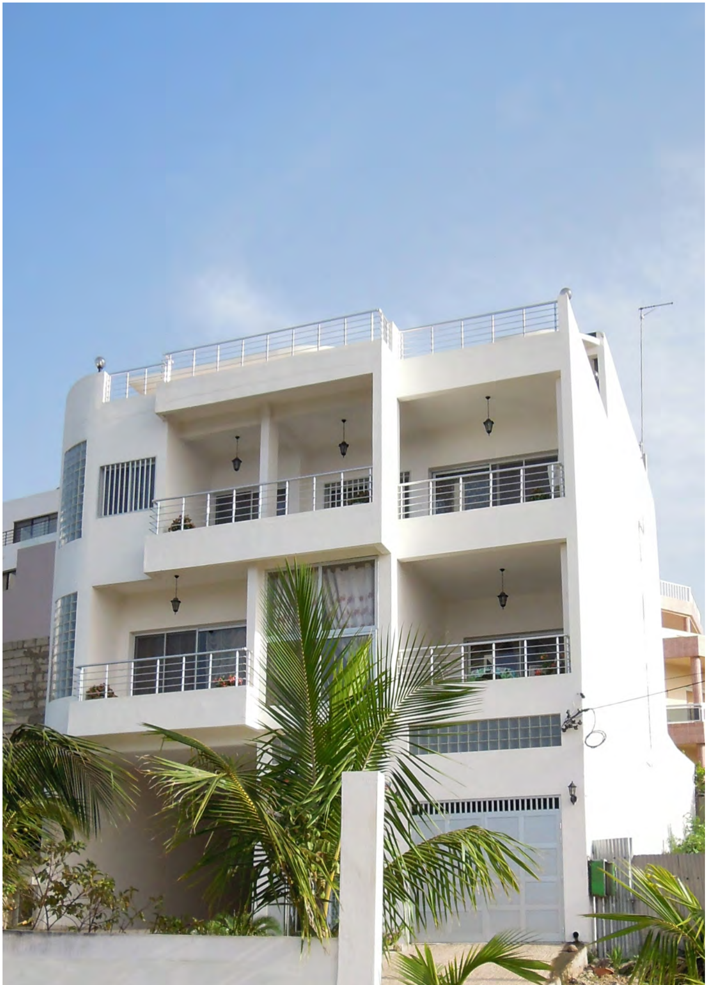
Habitation à Dakar. Les teintes claires contribuent significativement à diminuer l'absorption du rayonnement solaire.
