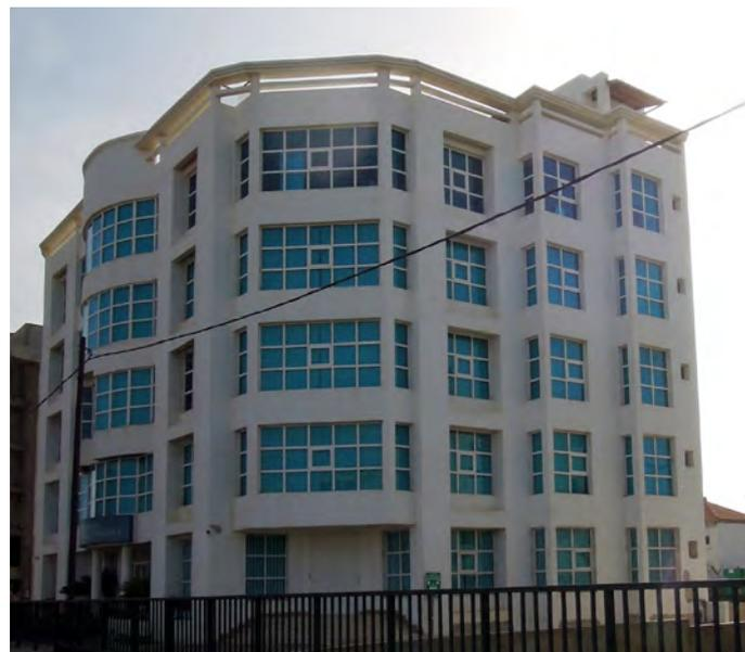
**Immeuble à Dakar. Les constructions récentes adoptent de plus en plus un style international avec de grandes surfaces vitrées sans protection solaire et souvent avec des capacités de ventilation naturelle limitées. Le recours à la climatisation devient indispensable au confort des occupants. Elle peut s'avérer extrêmement énergivore.**
