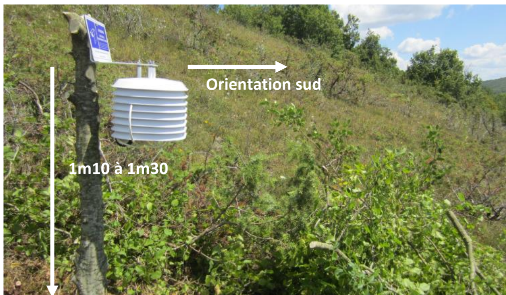
Fig. 8. Station météorologique sur un site d'étude du programme les sentinelles du climat en pelouse calcicole.
