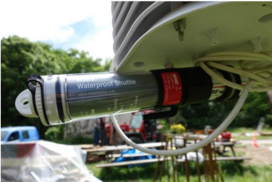
Fig. 9. Navette de transport connectée à l'enregistreur de la station Hobo®.
