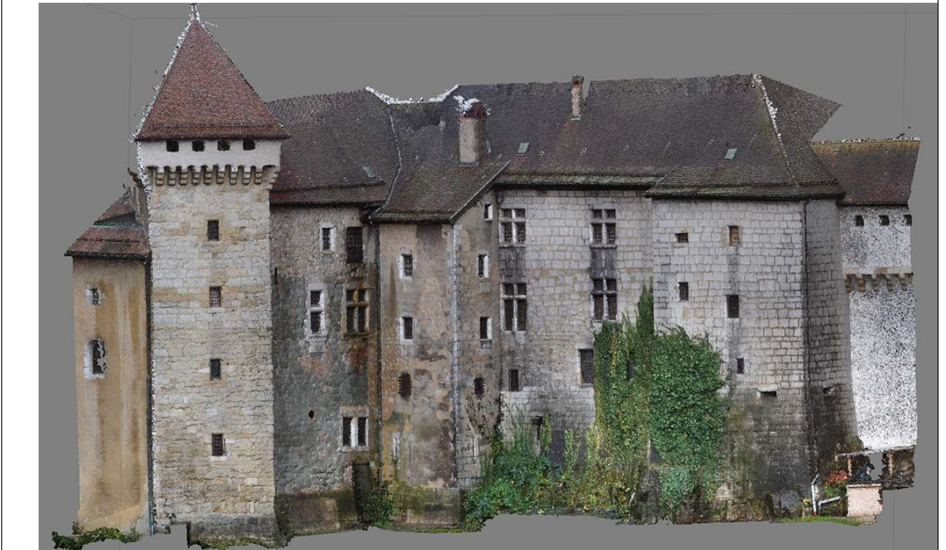
Nuage de points 3D issu du traitement photogrammétrique, vue d'ensemble de la zone d'étude
