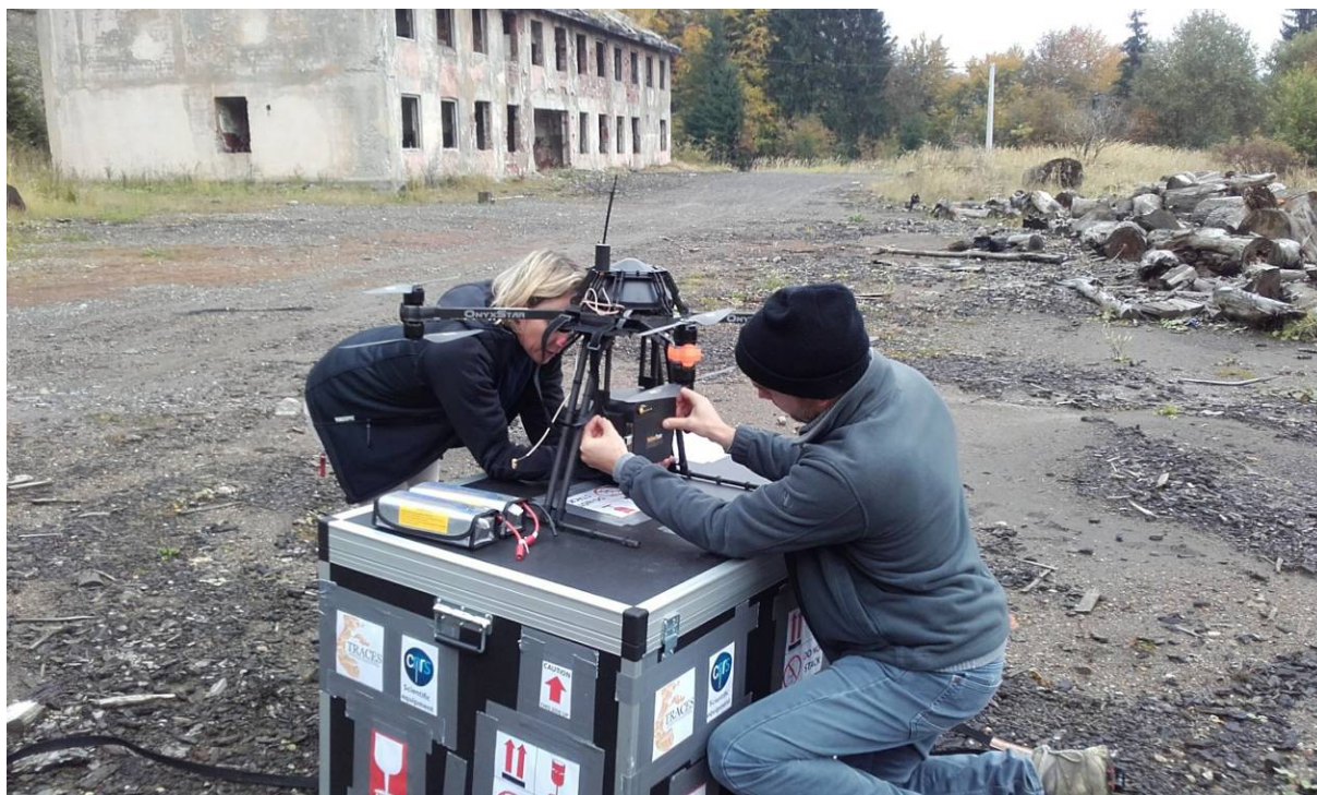
Figure 30 - Drone octorotor équipé d'un capteur Lidar (Yellowscan) – (Photo. V. Py)
