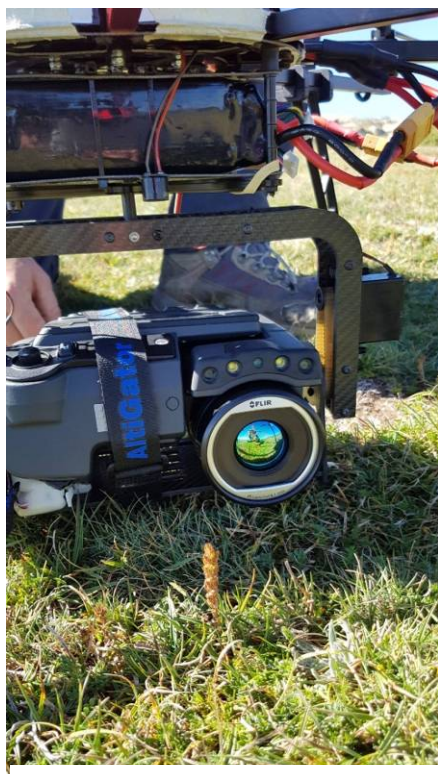
Figure 31 - Drone octorotor équipé d'une caméra thermique Flir T620 – (Photo. C. Calastrenc)
