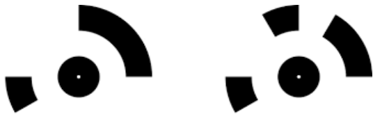
Figure 104 - Exemple de cible codée Photoscan
