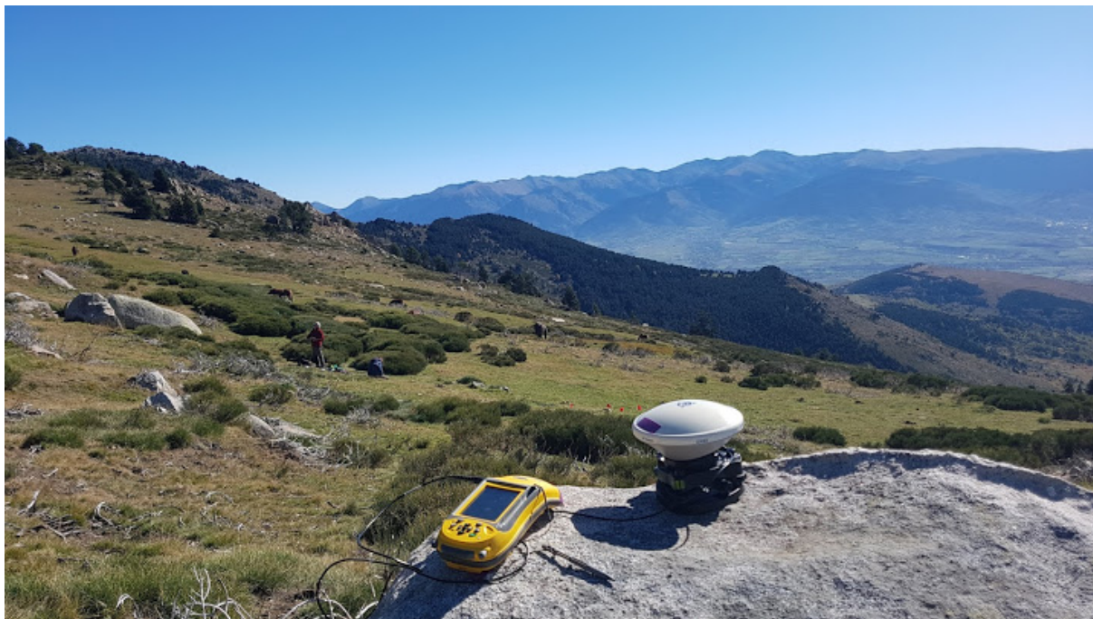
Figure 28 - Base DGPS (Trimble GeoXH3000 Série) – (Photo. C. Calastrenc)
