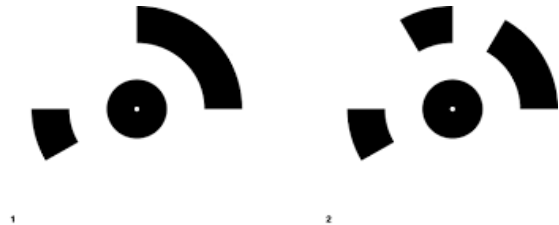
Figure 143 - Exemple de cible codée Photoscan
