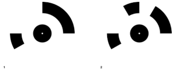
Figure 143 - Exemple de cible codée Photoscan
