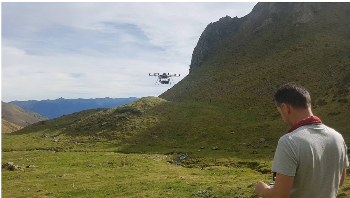
Figure 29 - Drone octorotor équipé d'un appareil photographique numérique Canon G1X – (Photo. C. Calastrenc)
