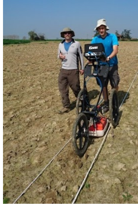
Figure 52 - Relevé au géoradar (Photo Poirier. Nicolas)
