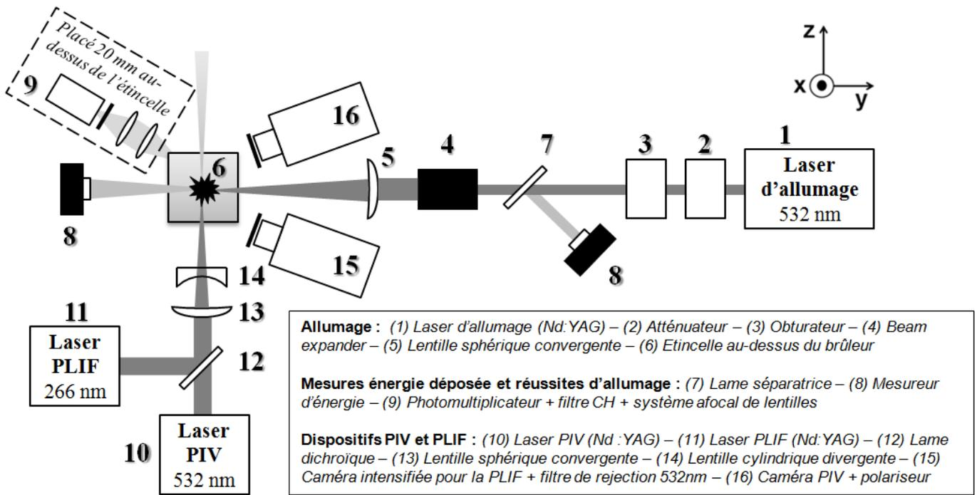
Figure 2 – Dispositif de mesure et d'allumage (vue de dessus)
