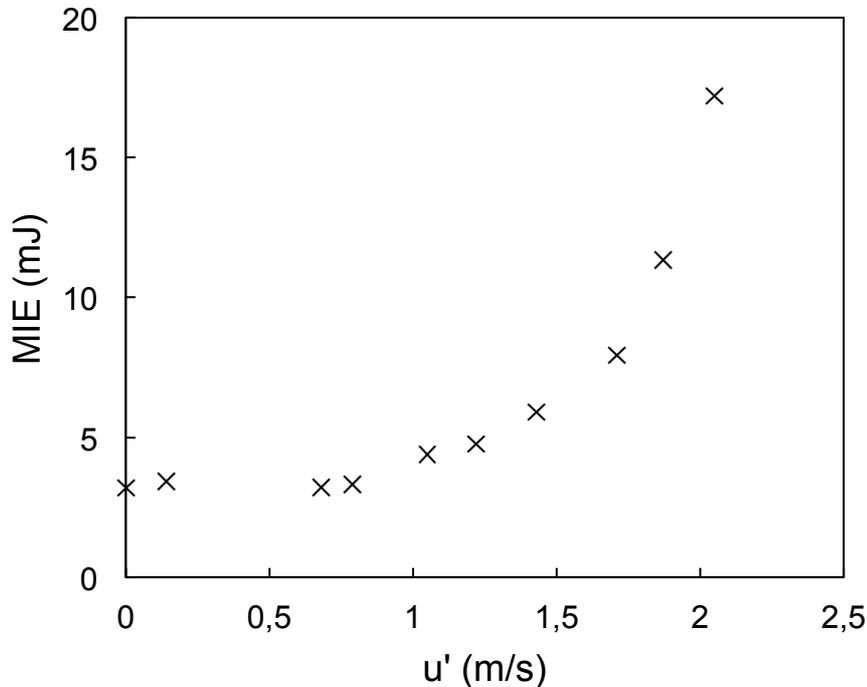
Figure 3 – Mesure de l'énergie minimum d'allumage (MIE) en fonction de  $u'$  pour un écoulement prémélangé de richesse  $\Phi = 0.55$  (la composition du combustible et du comburant sont donnés dans la partie 2.)
