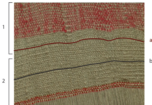
Fig. 7 : 1-Section de tissu où le fil de chaîne est attaché directement aux pesons; 2-Section où les barres d'attache sont utilisées ; a: Ondulations visibles de la trame de la première section; b: Ondulations de la seconde section.
