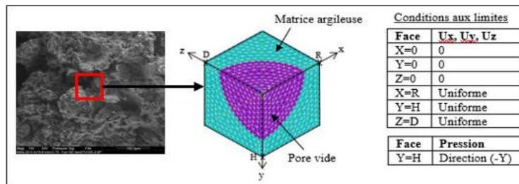
Figure 3. Modèle de cellule unitaire et conditions aux limites, (a : analyse MEB sur surface fraîchement cassée de l'éprouvette lyophilisée, b : cellule cubique périodique (VER), c : conditions aux limites)
