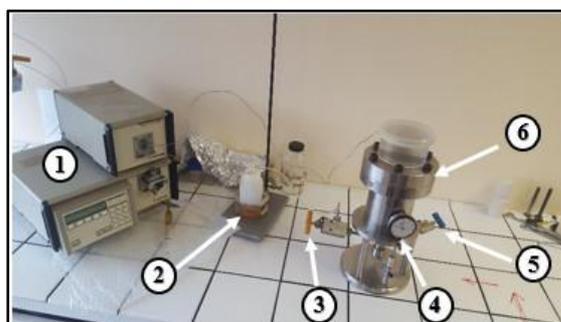
**Figure 1.** Dispositif expérimental, (1 : pompe de pression, 2 : l'huile de pression, 3 : vanne d'évacuation, 4 : Manomètre de déplacement, 5 : vanne d'alimentation, 6 : cellule œdométrique)
